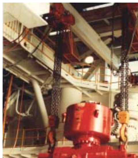
System wciągarek do przenoszenia „Blow Off Preventers”. Dwa lub cztery wciągarki z wychylnymi wózkami o łącznym udźwigu do 4 x 100 ton.
